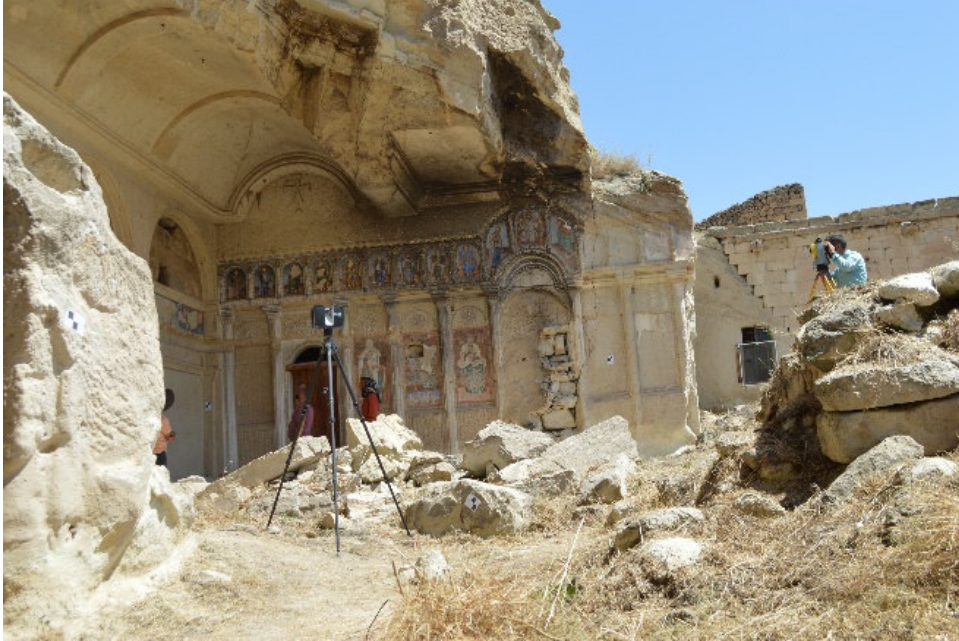
Şekil 13. Lazer Tarama ve Total Station ile Belgeleme (Ertürk, 2022)
