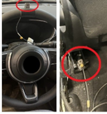
Şekil 6. Direksiyon ve koltuk kızıağından ivme ölçümü
