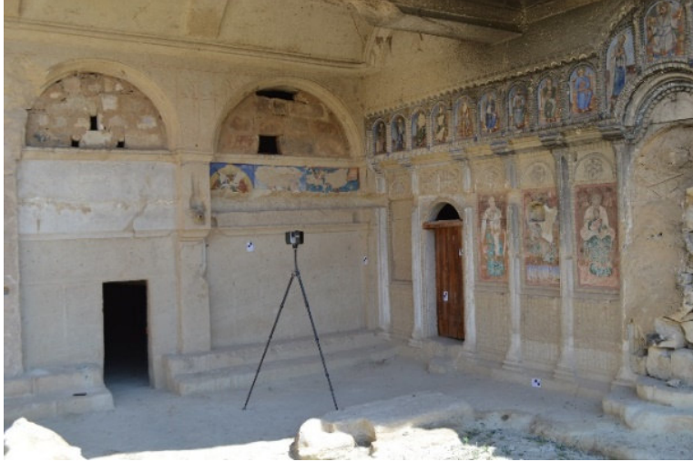
Şekil 4. Lazer Tarama ile Belgeleme (Uslu, 2022)
