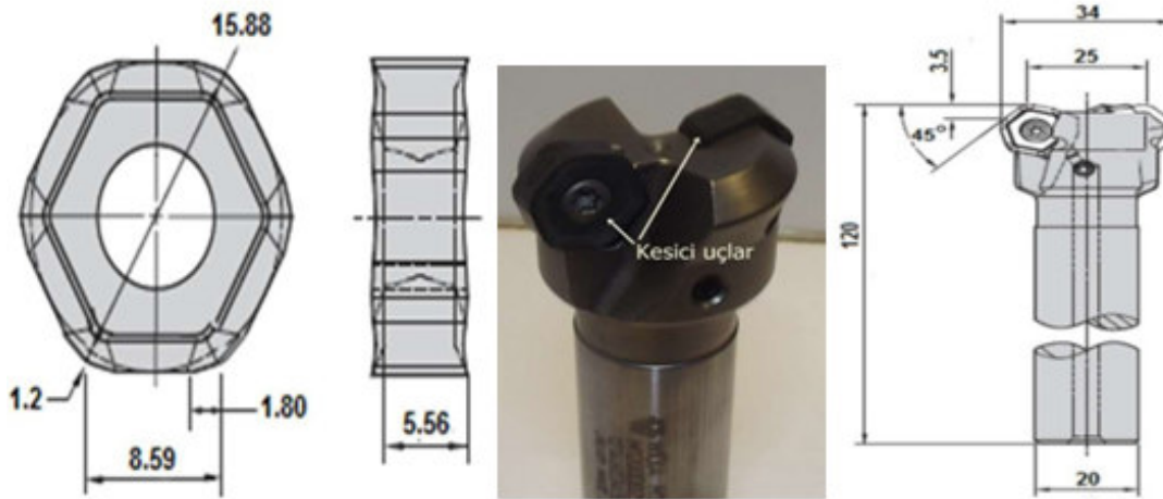
Şekil 2. Kullanılan Takım Tutucu ve Kesici Uçların Detayları
